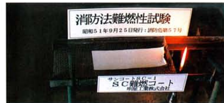
消防法57条による難燃性試験
