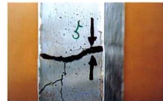
両引試験により確認された サンコートSC-1のひびわれ追従性を示す。
