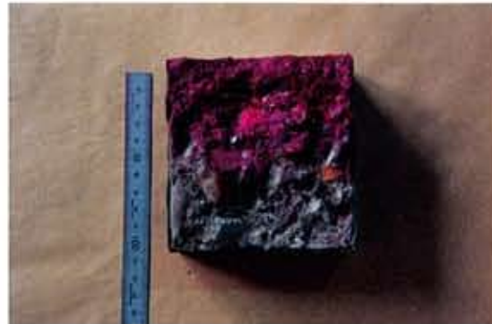
特殊防錆剤のコンクリートへの浸透力の確認 着色部分が浸透深さを示す。
